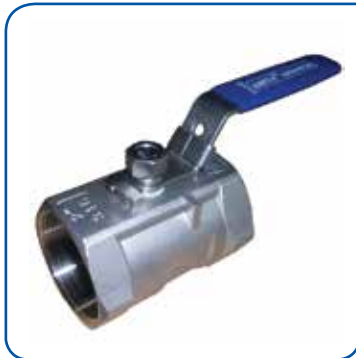
BALL VALVE 1 PC BODY Body : SUS 304 / 316 Size : 1/4" - 4" Conn : BSPT 1000 WOG PTFE Seat
