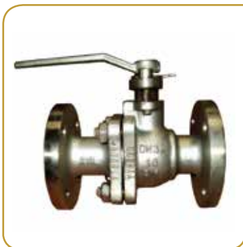
MARINE BALL VALVE Body : SUS 316 Size : 1/2" - 4" Conn : JIS 5K
