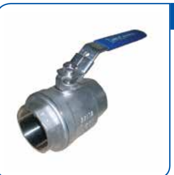
BALL VALVE 2 PC BODY Body : SUS 304/316 Size : 1/4" - 4" Conn : BSPT 1000 WOG PTFE Seat
