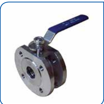
BALL VALVE 1 PC BODY Body : SUS 304 / 316 Size : 1 1/2" - 8" Conn : Flange End PN16 PTFE Seat
