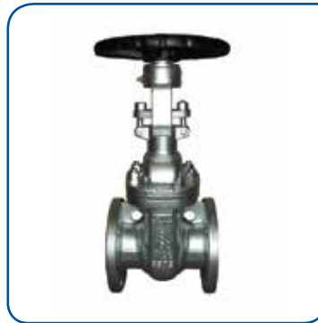
ARITA GATE VALVE Body : Cast Steel / WCB A216 Size : 1/2" - 12" Conn : ANSI 150 / 300 / 600
